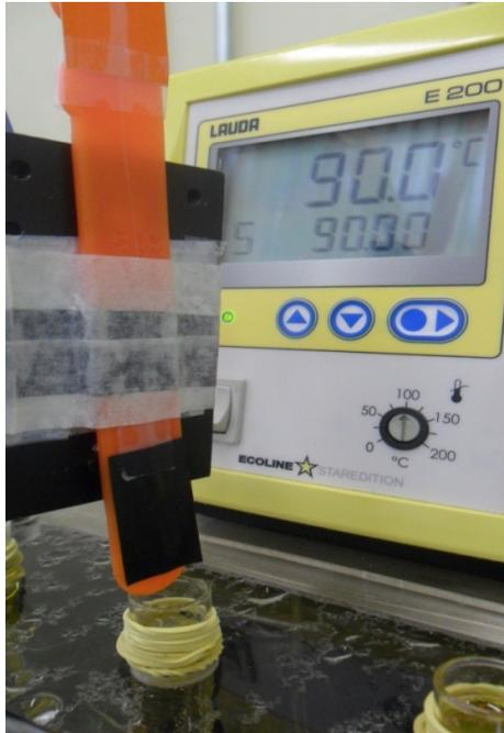
Figura 12 – Fotografia da rede imersa em amostra mantida sob temperatura de  $(90,00 \pm 0,01)$  °C em banho térmico.
