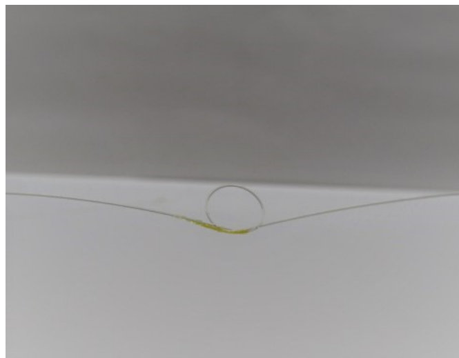
Figura 7 – Anel de fibra ótica fixado com um laço simples utilizado para fabricação de transdutor baseado em macrocurvatura.
