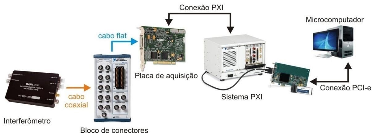
Figura 16: Blocos do sistema de aquisição.
