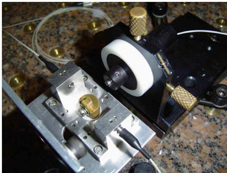
Figura 10 – Montagem final utilizada para permitir o melhor alinhamento e acoplamento de luz na lente sobre a qual é projetado o feixe refletido pelo polarizador separador de feixe
