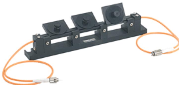
Figura 6 – Controlador de polarização
