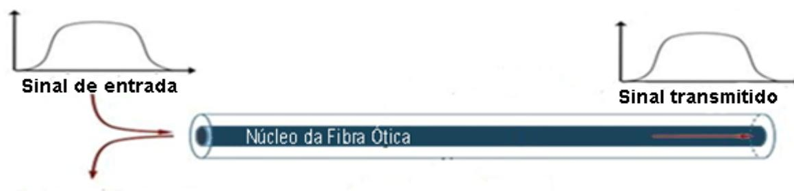
Figura 4 – Representação da propagação da radiação eletromagnética em uma fibra óptica sem modulação periódica no núcleo (adaptada de KASHYAP, 1999; OTHONOS e KALLI, 1999).
