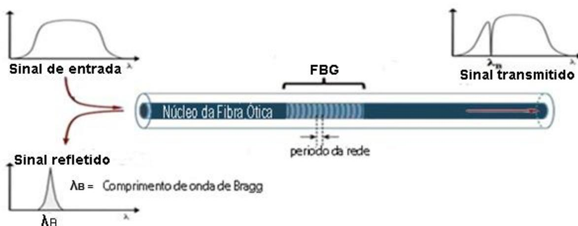
Figura 5 - Representação da propagação da radiação eletromagnética em uma fibra ótica contendo uma FBG (adaptada de KASHYAP, 1999; OTHONOS e KALLI, 1999).
