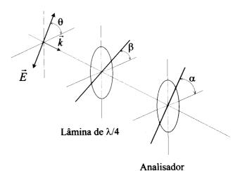
Figura 3. Diagrama esquemático da montagem experimental utilizada para a determinação dos eixos de birrefringência de um material.
