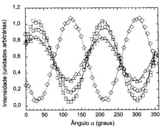
Figura 4. Gráfico da intensidade no detector em função do ângulo  $\alpha$  de giro do analisador, para quatro diferentes ângulos  $\theta$  do polarizador:  $\square$  ( $\theta=0^{\circ}$ ),  $\circ$  ( $\theta=30^{\circ}$ ),  $\triangle$  ( $\theta=40^{\circ}$ ),  $\diamondsuit$  ( $\theta=90^{\circ}$ ). Os pontos de máxima e mínima intensidade correspondem as posições angulares dos eixos de birrefringência do material.
