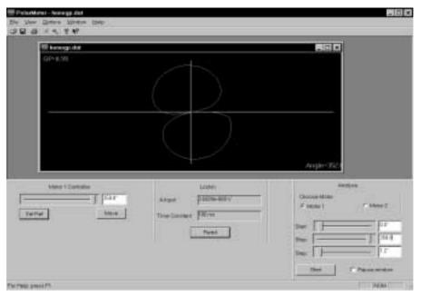
Figura 2. Aspecto da tela de aquisição do programa do equipamento desenvolvido, mostrando a determinação do grau de polarização de uma fonte luminosa. O gráfico em coordenadas polares mostra a intensidade no detector para cada ângulo do analisador.
