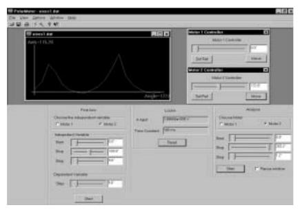
Figura 5. Aspecto da tela de aquisição do programa de equipamento desenvolvido, mostrando a determinação dos eixos de birrefringência de um material. O gráfico em coordenadas cartesians mostra a intensidade no detector para cada ângulo do analisador.
